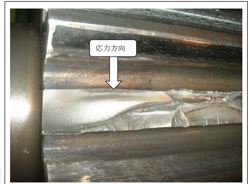
波面の観察結果では、下げ方向に応力が掛かった疲労文様が見られます。添付の荷重計算書を参照下さい。
