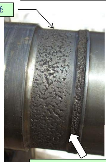
※軸の摩耗状態でマウスリングとこすれて運転中でした。シーチー音
